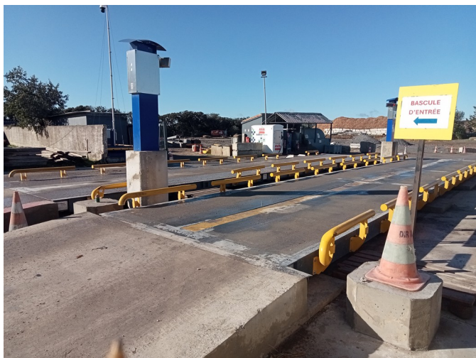
Mise en service d'un second pont bascule
